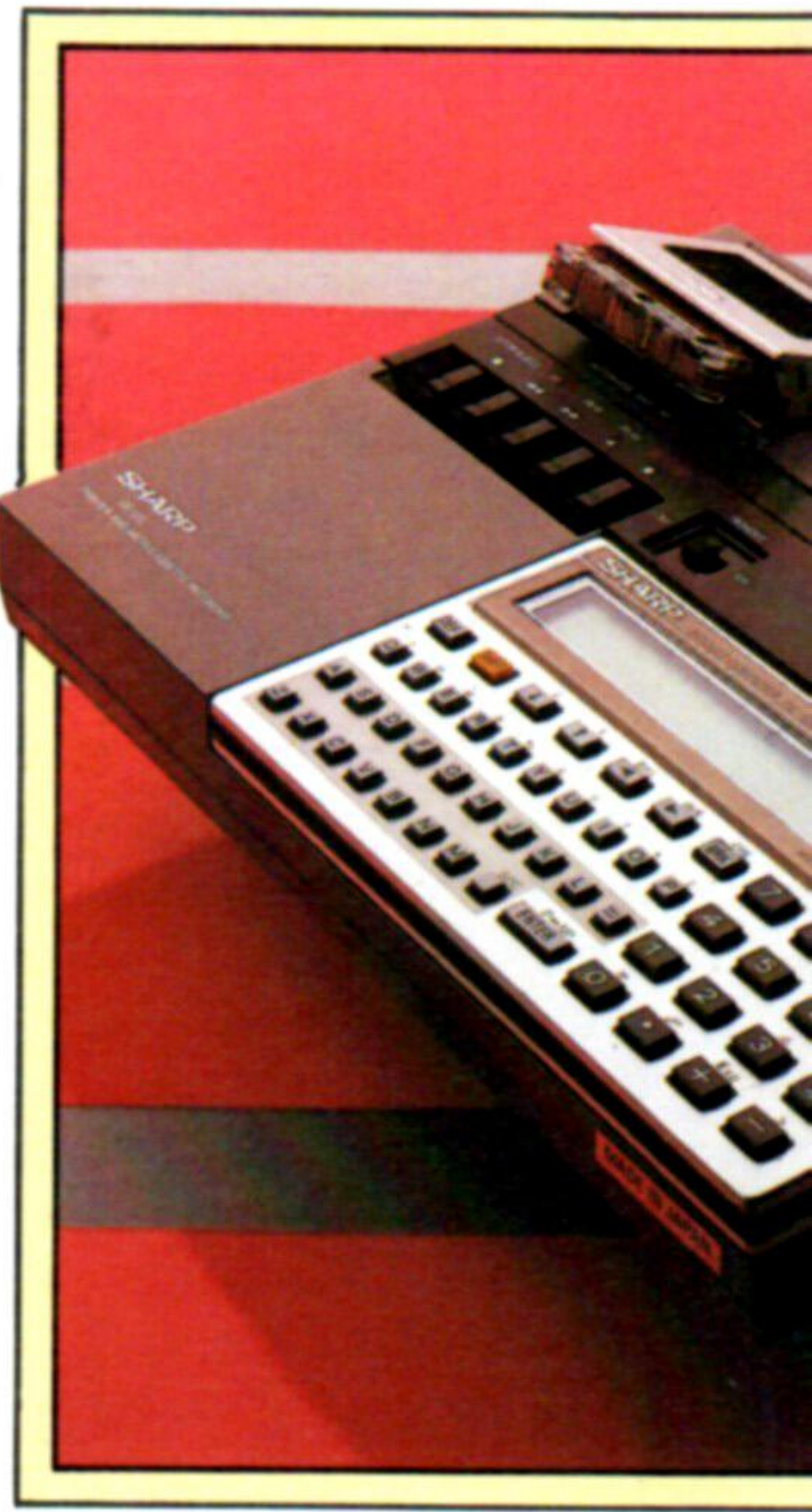
Puerta para cartuchos Esta interface permite instalar en el PC-1500 paquetes de RAM adicional. También se puede conectar a la interface para impresora/cassette o a una interface RS232
