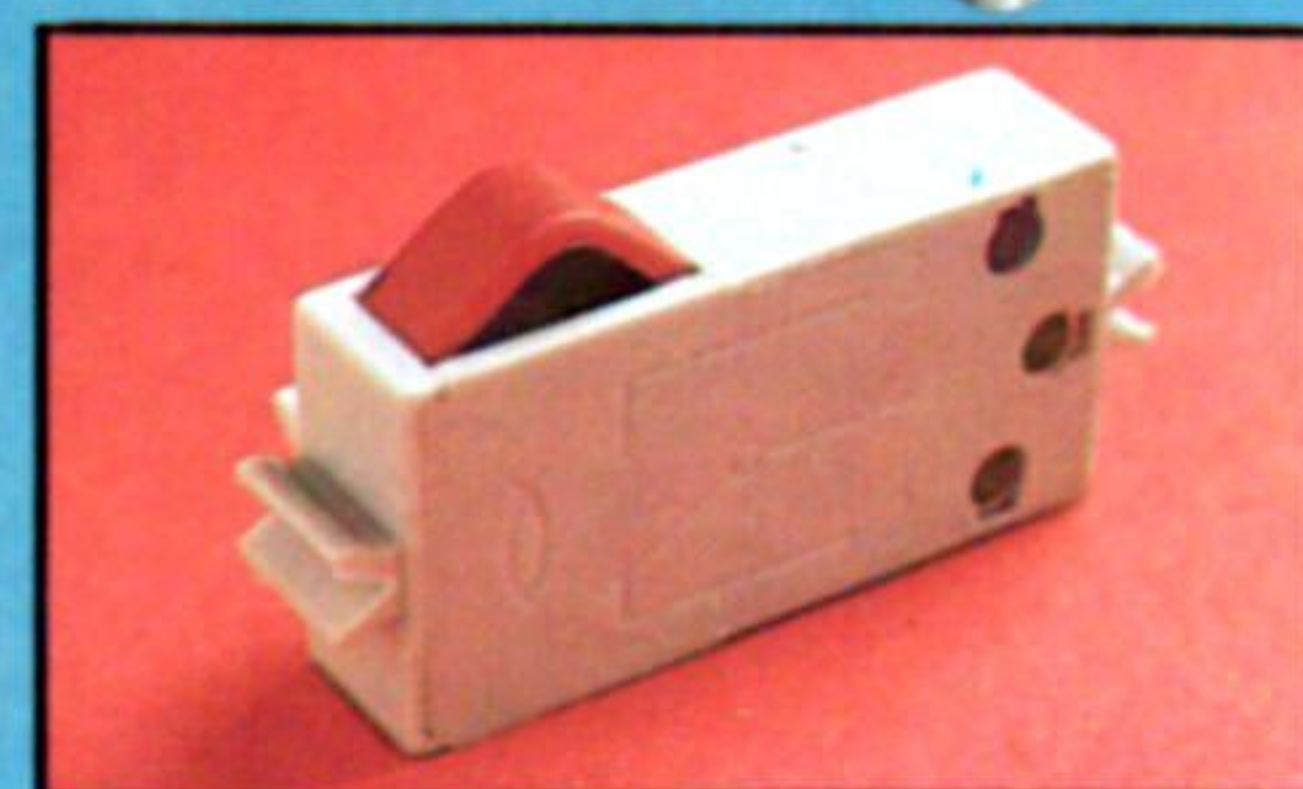
Interruptor Al pulsar una combinación de los ocho interruptores se genera un número en el registro de la puerta para el usuario, mediante el cual se puede utilizar el registro de dirección de datos para controlar al robot directamente
