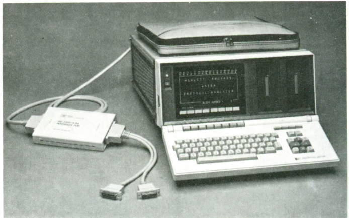
Figura 39. Analizador de protocolos. Permite «ver» los paquetes de datos transmitidos a través de un enlace de red.
