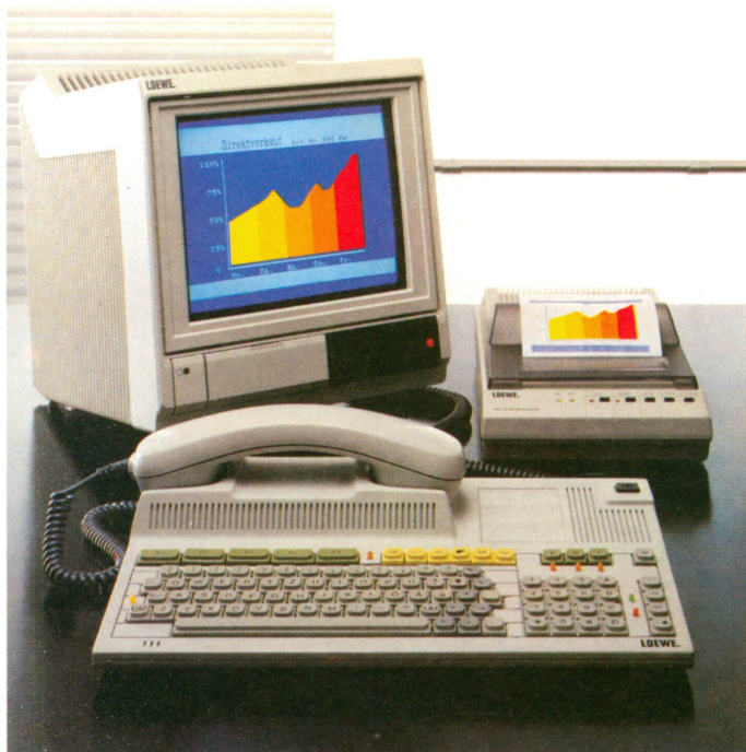
Computador de videotexto por teléfono de la firma Loewe. Con este equipo se establece la comunicación entre el usuario y un computador central, o banco de datos. La información es capaz de ser representada en una pantalla y quedar plasmada en una impresora a color.
