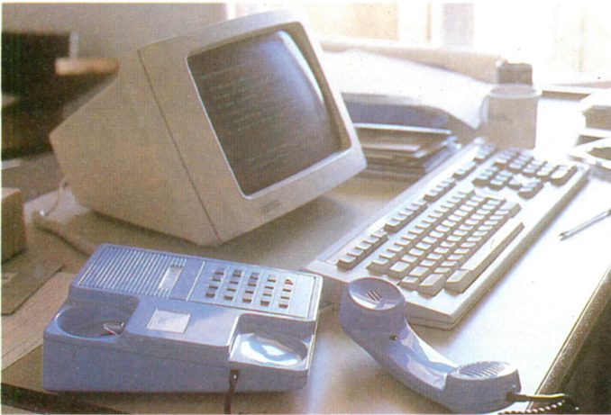
Computador personal, que vía telefónica es capaz de conectar con las redes de datos para proporcionar y procesar una información complementaria. Puede utilizar también adaptador acústico telefónico, para la transmisión de datos. (Cortesía: Standard Eléctrica).
