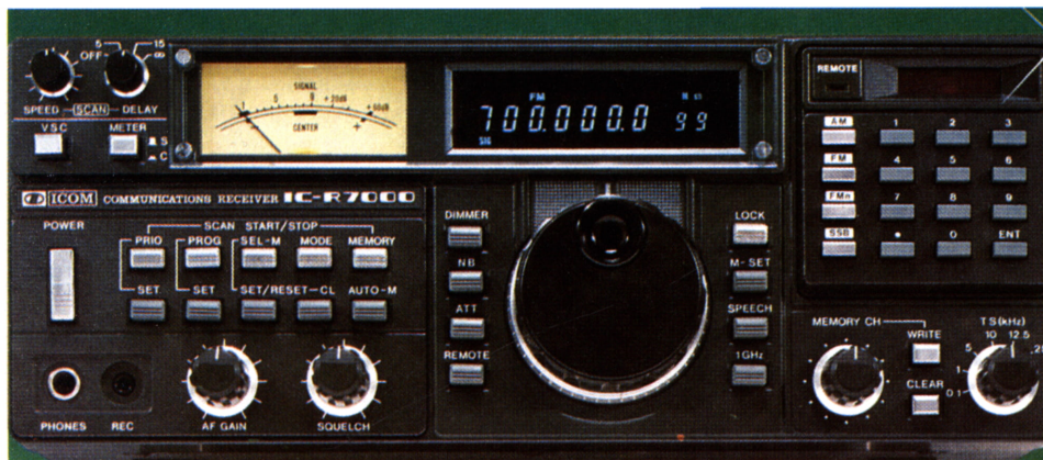
Figura 29. Receptor modelo ICOM IC-R7000, preparado para trabajar en FM con banda ancha y banda estrecha, AM y SSB. Posee 99 memorias y sintonía automática.
