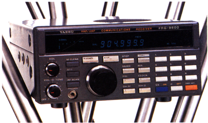
Receptor Yaesu FRG-9600 con 100 canales de memoria.
