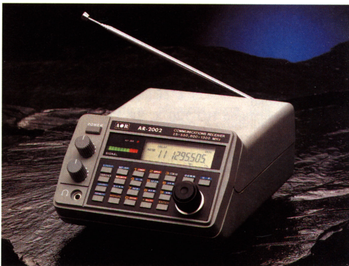
Monitor profesional modelo AR 2002 para recepción de señales en casi la práctica totalidad de la banda. (Cortesía: A & R).
