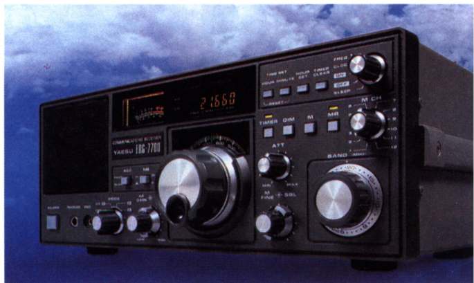
Receptor Yaesu FRG-7700 que trabaja en 30 bandas de frecuencia.
