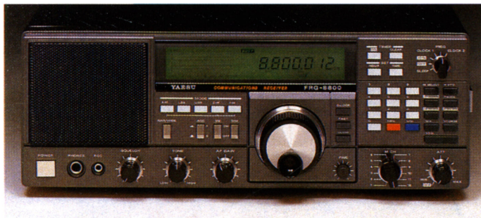
Receptor Yaesu FRG-8800 multiescanner, con indicador gráfico S/SINPO.
