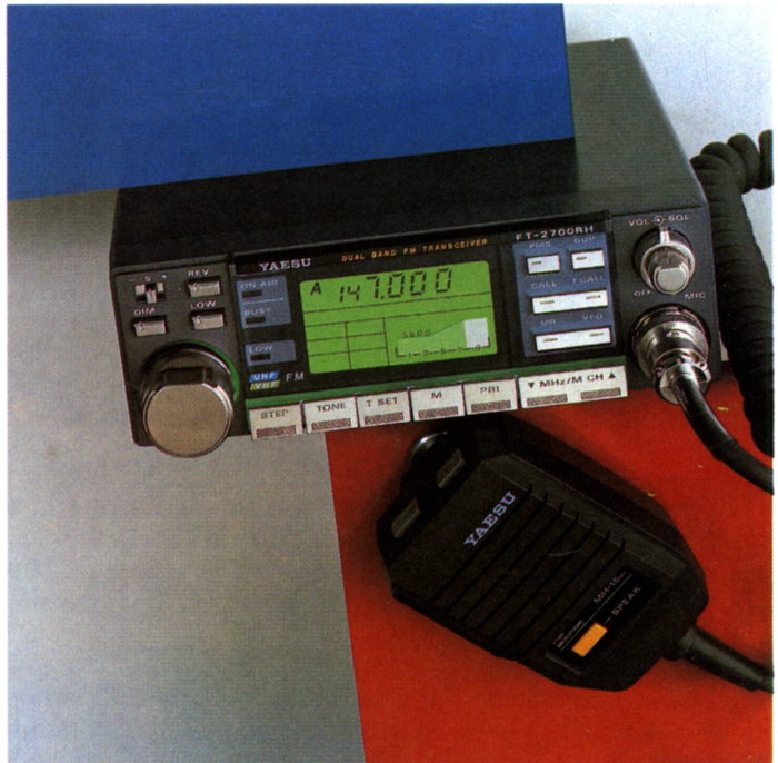
Yaesu presenta este modelo de transceptor que trabaja en UHF y VHF, preparado para su ubicación en automóviles o espacios reducidos. (Cortesía: Astec y Radio Watt).
