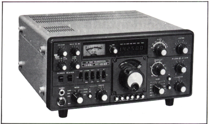
Yaesu FT 101 ZD, un transceptor que incluye pasos finales a válvulas. (Cortesía: Astec y Radio Watt.)
