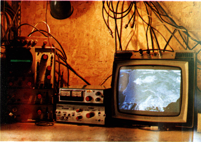
Recepción, conversión analógica|digital y monitor para recoger las imágenes transmitidas vía satélite. Equipo construido por EA3B|B.
