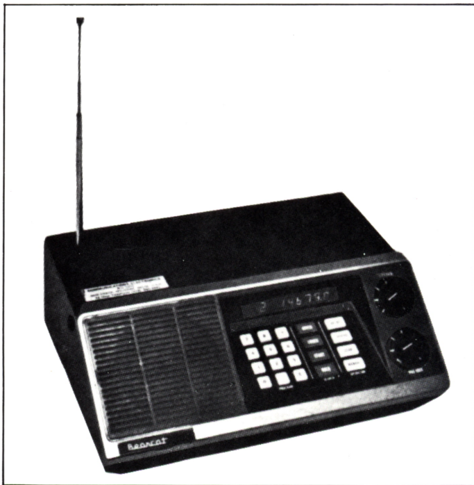
Figura 18. Receptor tipo explorador (scanner), modelo Bearcat- 220, de 32 a 52 MHz, para VHF y UHF.
