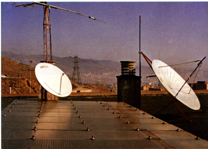
Conjunto de antenas receptoras, de construcción casera, para la recepción de señales por vía satélite.
