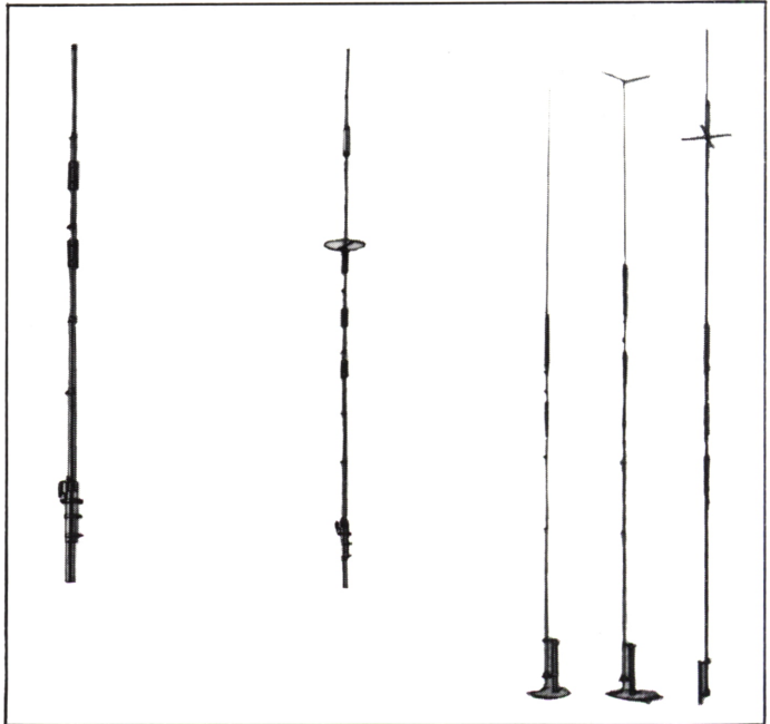
Antenas verticales para bandas decamétricas.
