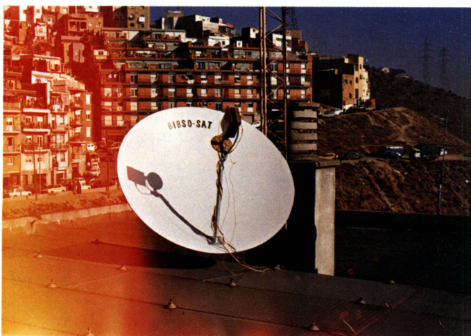
Antena y conversor para la recepción de señales procedentes del METEOSAT 2, y satélites geoestacionarios para la TV vía satélite.
