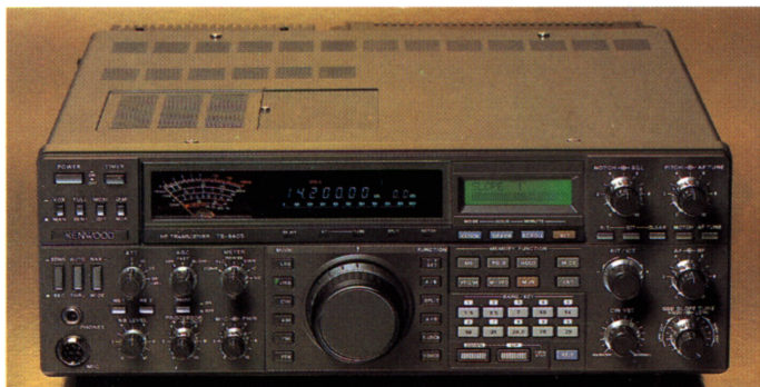
Transceptor Kenwood TS-940 S, uno de los modelos más completos de la gama. Una ojeada a los indicativos de cada botón de mando da idea de las amplias posibilidades del mismo. (Cortesía: DSE).
