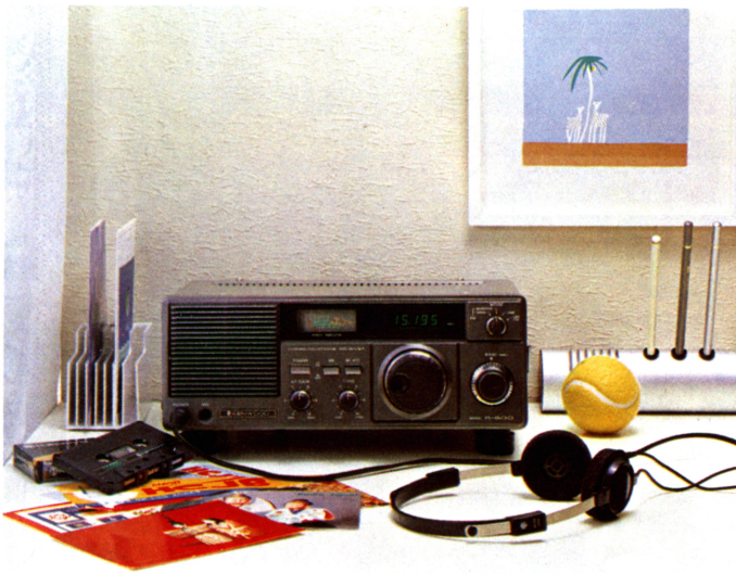
Receptor de cobertura general de 0,1 a 30 MHz. Corresponde al modelo R-600 de Kenwood. (Cortesía: DSE).
