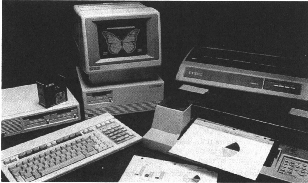
Figura 0.6. Computadora HP-150 con unidad central, pantalla y una serie de periféricos conectados a ella.
