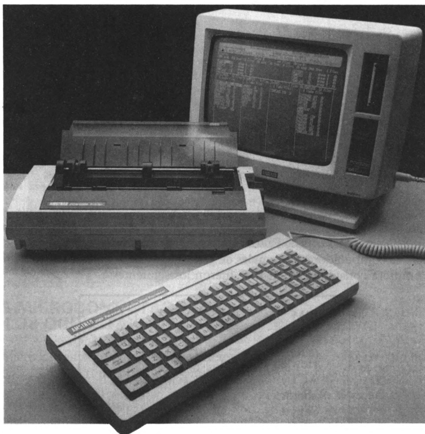
Figura 0.35. Computadora Amstrad 8256 diseñada específicamente para tratamiento de textos y con características semiprofesionales para gestión.
