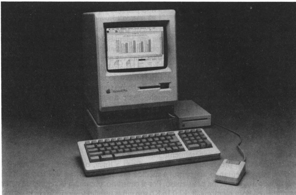
Figura 0.36. Computadora de reciente aparición Apple Macintosh Plus con unidad de disco y ratón.
