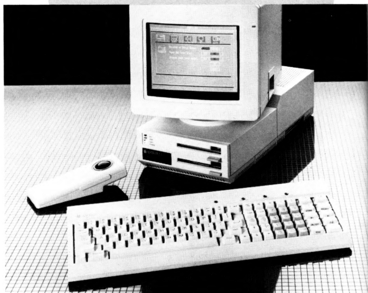
Atter nyt fra engelske Apricot. Her er det F2 modellen med 512K RAM og to 720K floppy'er. Computer kører som standard med Digitals GEM, der bygger på symboler og ikoner hele vejen igennem.
