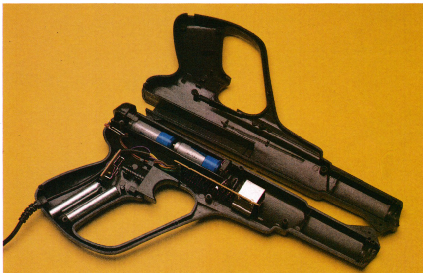
En esta foto podemos distinguir con claridad los contrapesos, la alimentación (cuatro pilas) y el circuito de la pistola.
