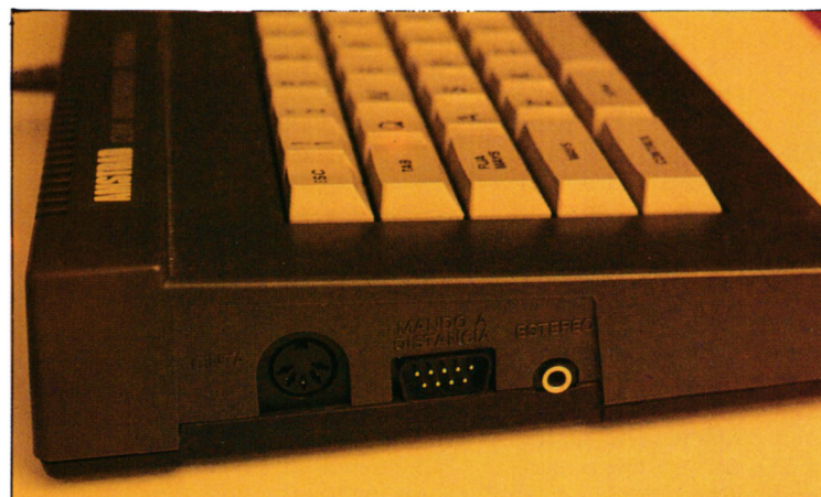
En esta foto podemos observar la toma de cassette, la salida de audio y el conector para el joystick de un A m s - tad CPC.
