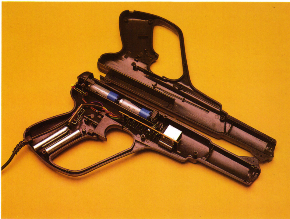
En la foto, los principales componentes de la Gunstick.
