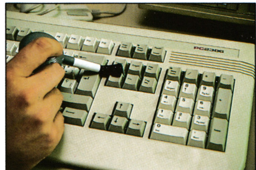
La ceniza y el polvo en los teclados puede originar problemas de contacto en las teclas.
