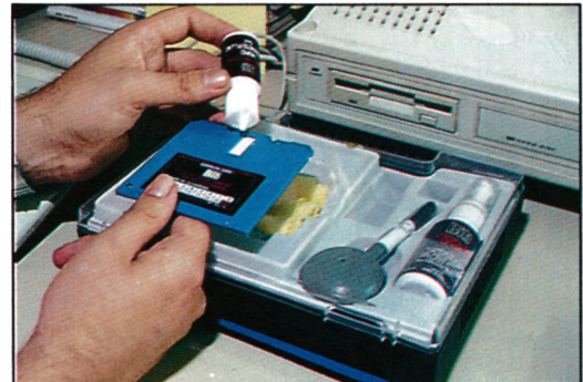
El disco-limpiador se rocía con la solución no abrasiva que permite limpiar las cabezas sin desgastarlas.
