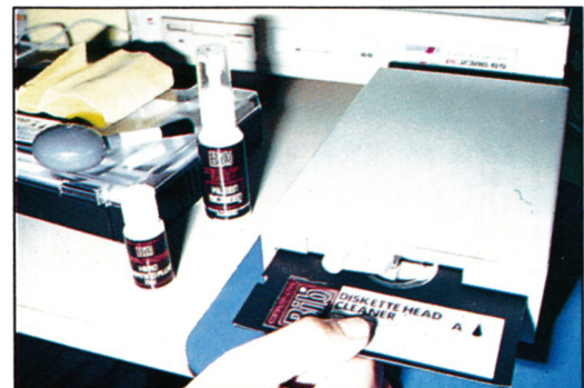
El disco-limpiador se rocía con la solución no abrasiva que permite limpiar las cabezas sin desgastarlas.
