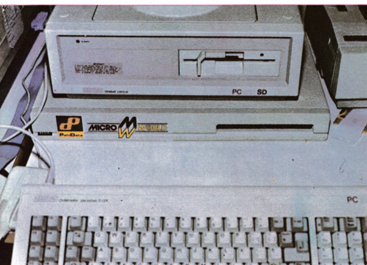
Unidad Télex PahlData. Permite utilizar un PC como terminal télex de manera asíncrona, mientras se trabaja con el ordenador.
