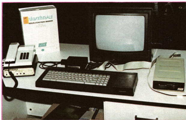
Modem multifunción Nightingale y disco de 5 1/4 para 6128, de Agroinformática, faciliten las comunicaciones y el trasvase de datos con el PC.
