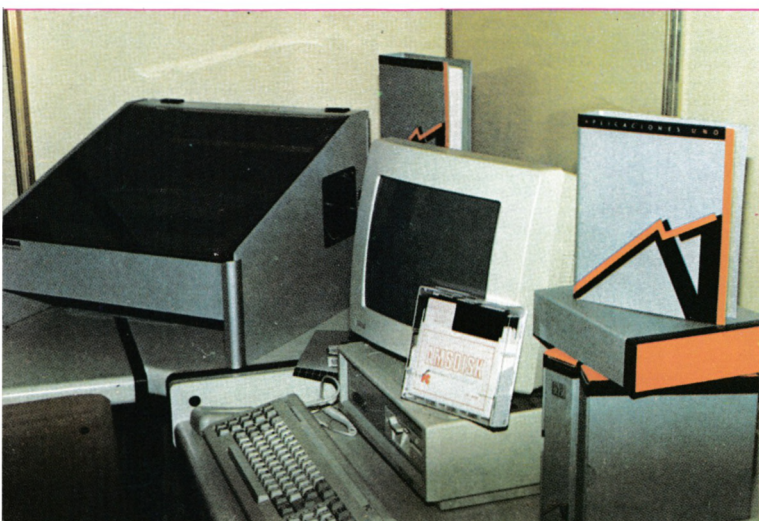
El procesador de textos Alfa 1, totalmente en castellano, junto a los diskettes de 5 1/4 de Infor Ofic, y a una cabina insonorizada para impresora.
