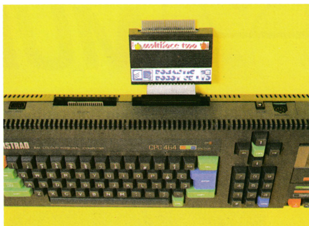
El Multiface dos conectado a un Amstrad CPC 464.
