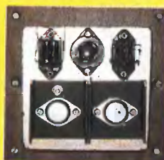
DETALLE DEL AMPLIFICADOR DE 20 W INCORPORADO EN CADA ALTAVOZ
