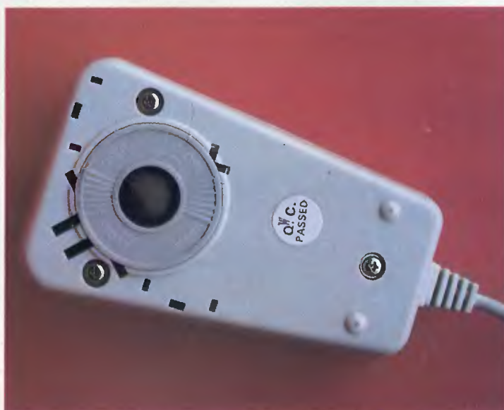
En la cara inferior puede verse la bola, cuya extracción resulta muy sencilla.
