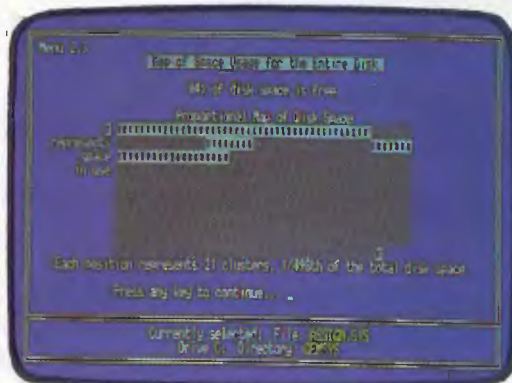
Mapa de un disco duro de 20 Mbytes obtenido por el programa NU.COM de las Norton Utilities.
