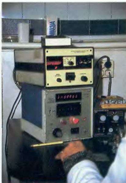
Sistema de control de Ajuste de Frecuencia, que será sustituido próximamente por un PC Amstrad con software diseñado por el Departamento Técnico de INYSA.
