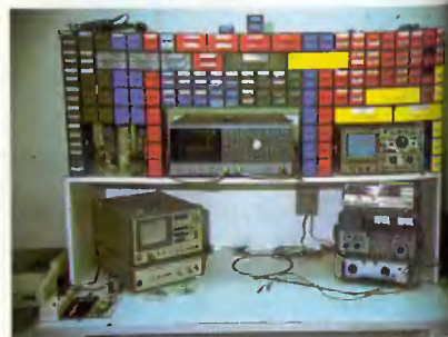
Puesto de laboratorio para control de calidad de los cristales en los radioteléfonos u otros equipos de comunicaciones.
