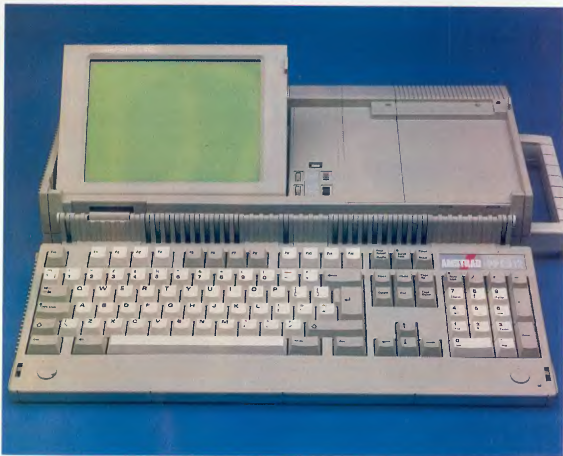
Aspecto del PPC 512 D en posición de trabajo. La inclinación de la pantalla puede ajustarse en seis posiciones diferentes. A la izquierda de la pantalla pueden verse el control de contraste y el de volumen del altavoz interno.
