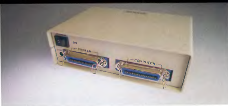
Conectores de impresora y de ordenador, situados en la parte posterior del buffer.
