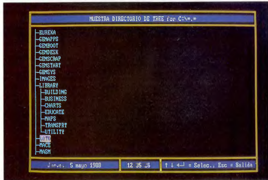
Representación gráfica en forma de árbol de la estructura de subdirectorios del disco duro.
