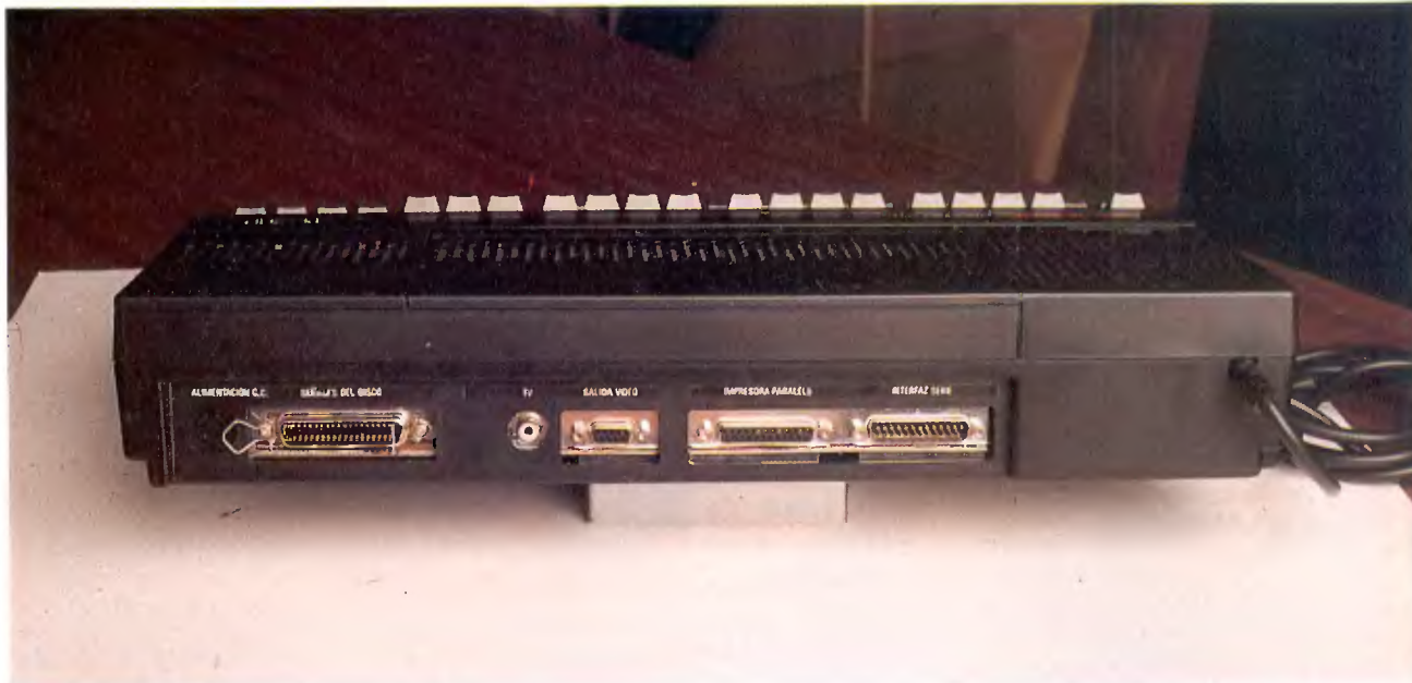
Frente trasero del Sinclair PC donde se sitúan, por la izquierda, los conectores para alimentación por baterías, una unidad externa de disco, TV, video y las salidas de los interfaces Paralelo Centronics y Serie RS-232. A la derecha de la foto aparece el cable de alimentación del PC 200.
