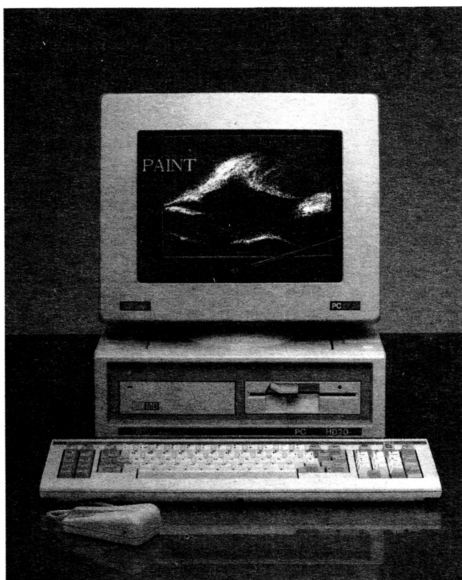
El modo de altísima resolución, 640 x 350 líneas, permite al PC 1640 ECD reproducir gráficos de extraordinaria calidad.
