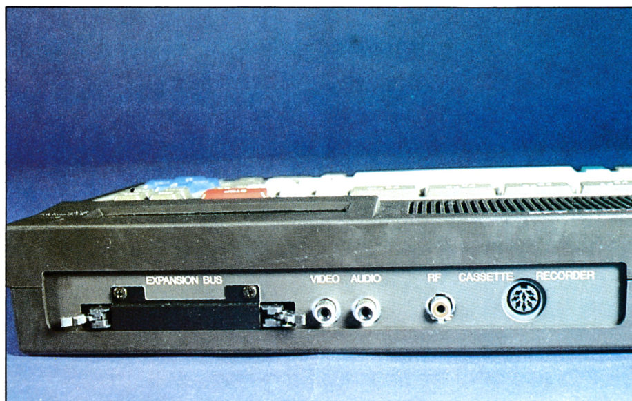
Expansión BUS, salidas audio, video y RF del Toshiba.
