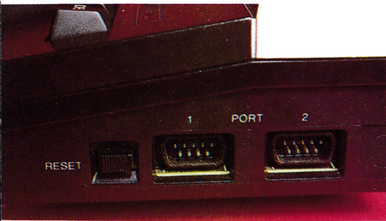
Conectores para Joystick del MSX.
