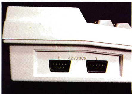
Conexión Joystick del Pectravideo.
