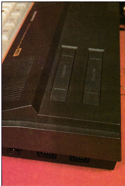
Conexión doble para cartuchos ROM del Sanyo.
