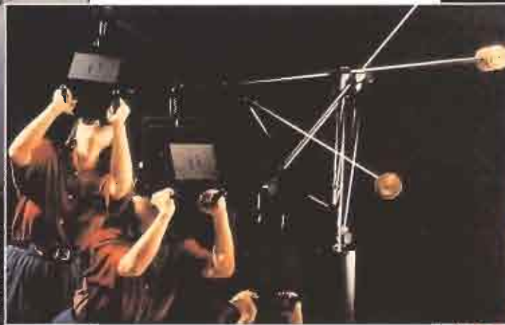
En conjunción con la empresa Fake Space Labs en SIGGRAPH, la NASA presentó BOOM, un nuevo interfaz de Realidad Virtual. Este sustituye el tradicional casco virtual por un display frente a los ojos, suspendido de un brazo articulado, que permite una visión en tres dimensiones, con un ángulo de 120 grados.
