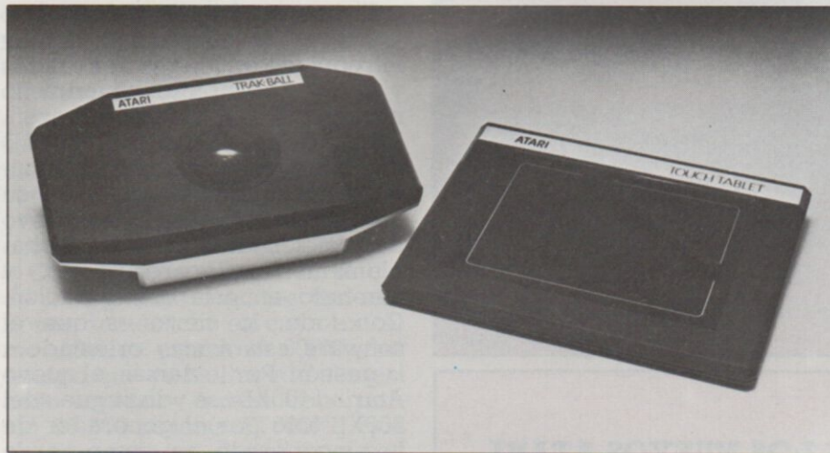
Control de la pantalla: Track-Ball y bandeja gráfica.
