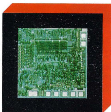
8080: Un microprocesador con arquitectura de 8 bits, repertorio de 78 instrucciones y capaz de direccionar 64 Kb.
