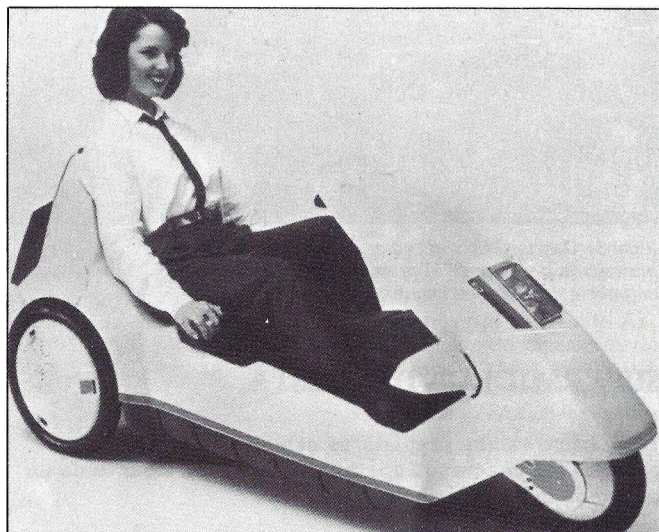
C5 de Sinclair. Este es el monoplaza eléctrico que acaba de lanzar al mercado británico Sir Clive Sinclair y que pronto estará en nuestro país. Tiene una autonomía de 33 kilómetros (66 con otra batería opcional) e incorpora unos «pedales», por si se le acaban las pilas.
