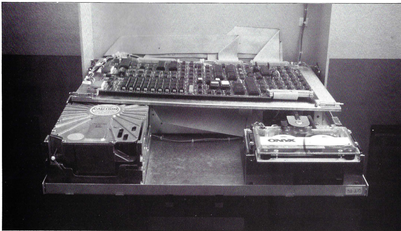
Foto del equipo abierto mostrando la modularidad de los elementos que los componen.
