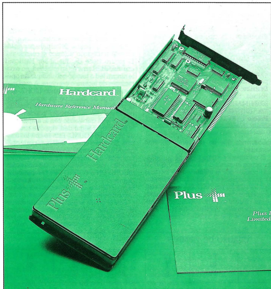
Integración al más alto nivel. Disco y controlador en una sola tarjeta.
