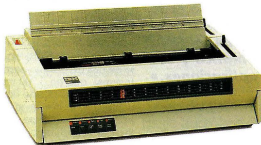
La Impresora IBM QuietWriter tiene alimentación semi-automática de hojas individuales y dispone también de una unidad opcional de alimentación automática de papel.
