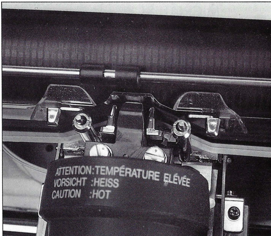
El cabezal de impresión dispone de la última tecnología de 24 agujas.
