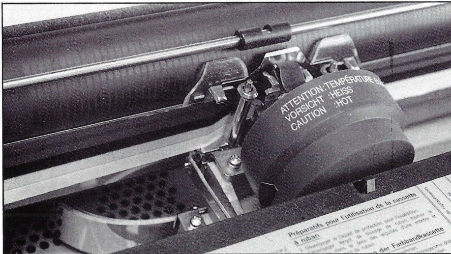
La modalidad de color dispone de una cinta de gran tamaño con cuatro colores.
