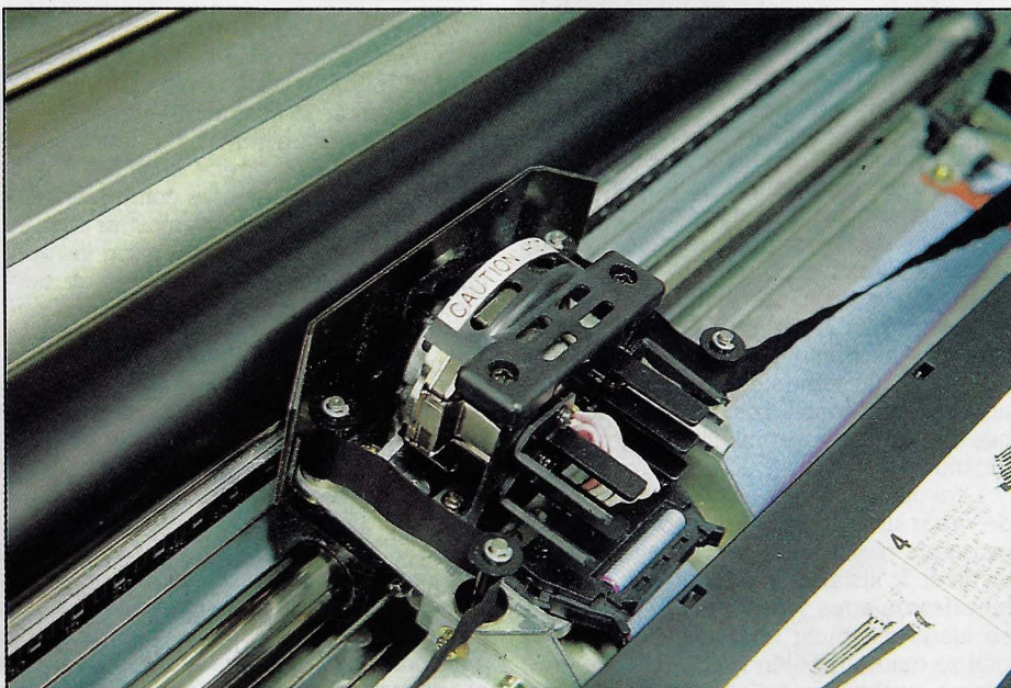
El cabezal de impresión dispone de nueve agujas.
