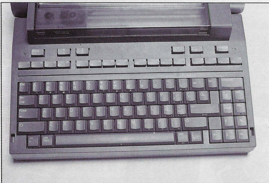
El teclado del Wang MIO tiene doble inscripción, una para la modalidad Wang y otra para la estándar.
