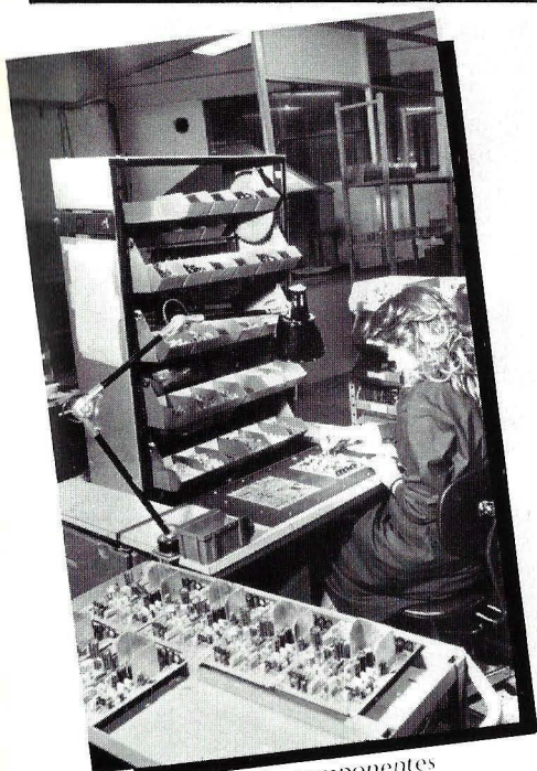
Fase montaje componentes sobre el "board".
