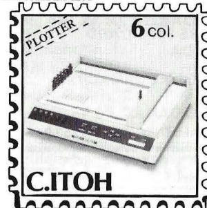
CX-6000 Bajo costo, Tipo plano DIN A4 INCREMENTO MINIMO 0,05 mm. VELOCIDAD 100 mm./s.
