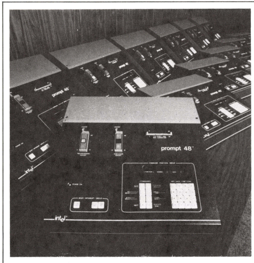
Photo 3. - L'ensemble PROMPT 48 (INTEL) permet de programmer le micro-ordinateur en un boîtier 8748 comportant 1 K-octet de mémoire effaçable aux U.V. (EPROM).
