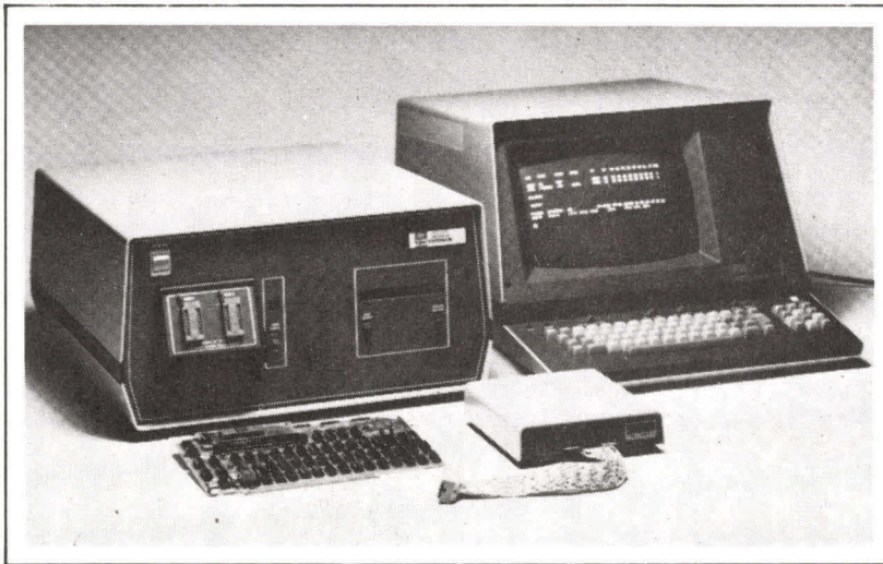
Photo 1. - Système universel d'aide au développement des microprocesseurs, Modèle 8001 (Tektronix).
