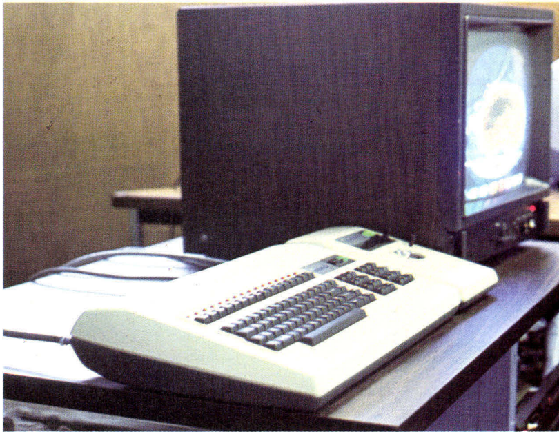
Photo 17. - Vue d'ensemble d'un système 3000 ; on trouve sur le plateau et de gauche à droite le clavier de l'opérateur, le manche à balai et l'écran couleurs. Sur la droite du meuble et de haut en bas se situent le LSI 11-03, le double floppy et le système 9000.
