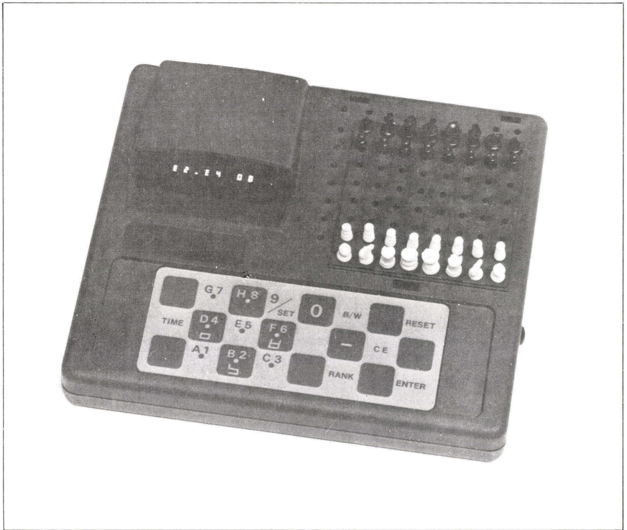
Le Boris Diplomat intègre dans un même boîtier un clavier à effleurement, un affichage numérique et l'échiquier proprement dit.
