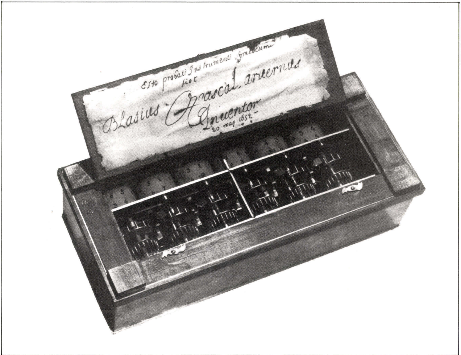
Blaise PASCAL, en 1652, réalisa une des premières machines à calculer. Au cœur de la machine un ingénieux mécanisme d'addition reposait sur de petites roues gravées de chiffres, avec un système de report des retenues à base d'engrenages faisant avancer des roulettes (totalisateurs).
