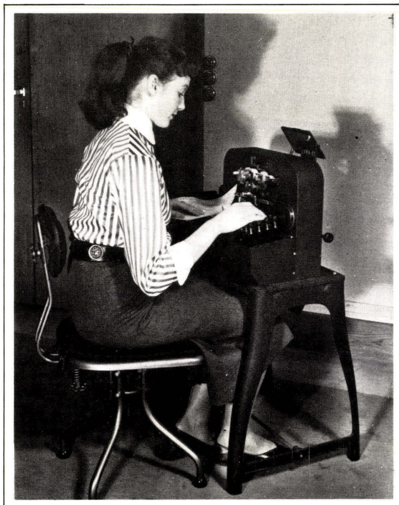
Photo 4. — Cette machine (1950) permettait de transcrire en perforations les renseignements lus sur les documents de base.
