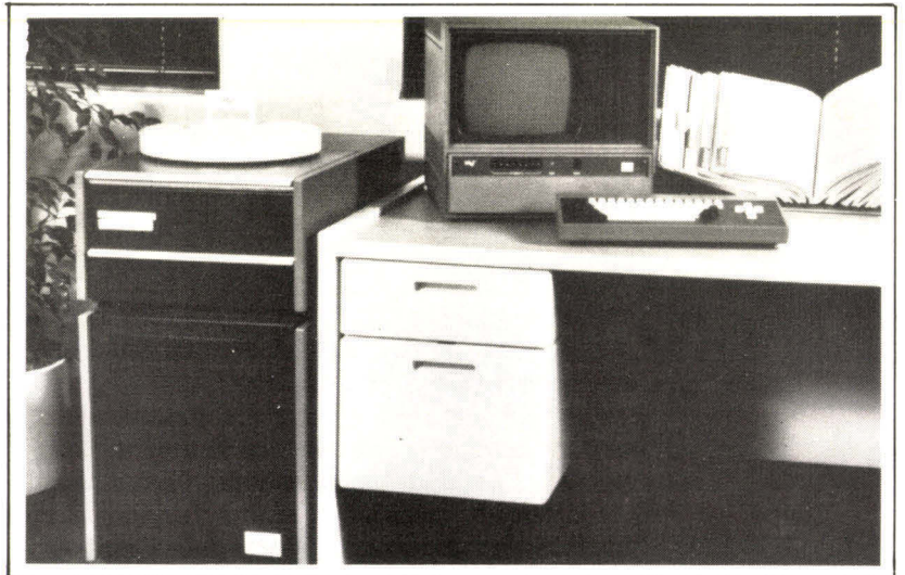
Photo 3. - L'« Intellec » est muni d'une mémoire de masse constituée d'un disque dur. (Doc. Intel.)
