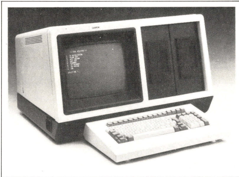
Le micro-ordinateur Toshiba T 200, une unité compacte intégrant un écran et deux disquettes double face, double densité.
