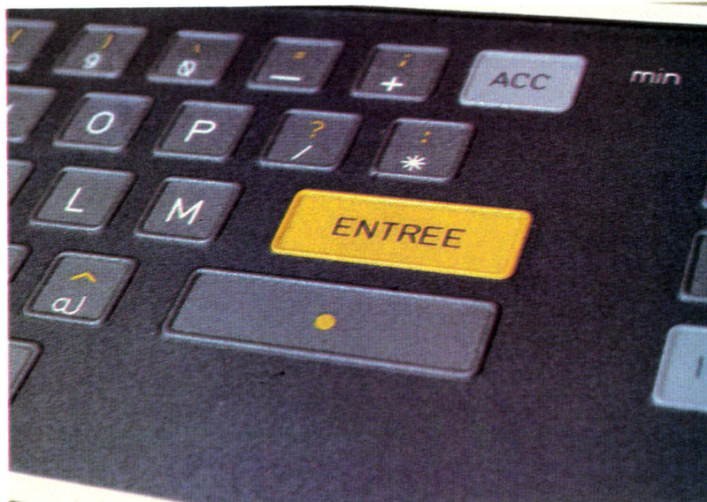
Détail du clavier à membrane. Celle-ci n'est pas tout à fait plane : les touches sont délimitées par un bord sensible au toucher.
