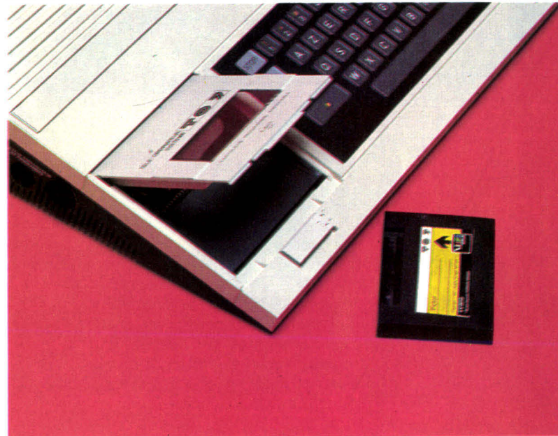
Le lecteur de programmes en mémoire morte et une cassette pouvant contenir jusqu'à 16 K-octets.
