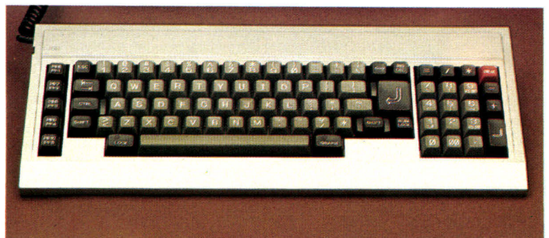
Le clavier du 555 : un ensemble de 85 touches réparties selon trois blocs.
