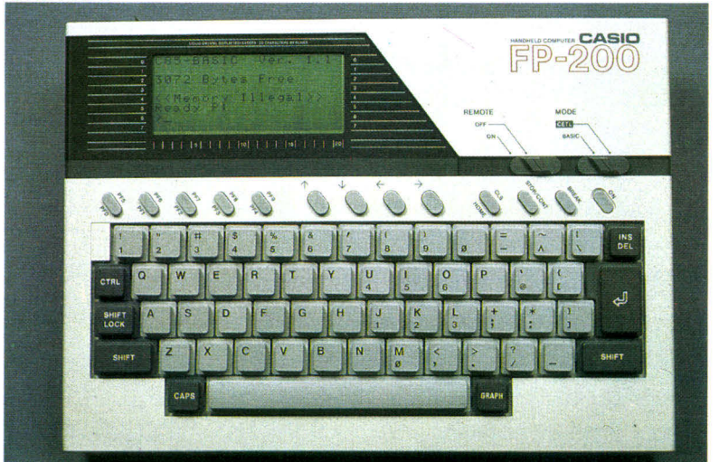
Le clavier, voisin de celui d'une machine à écrire, est doté de touches de fonctions redéfinissables.
