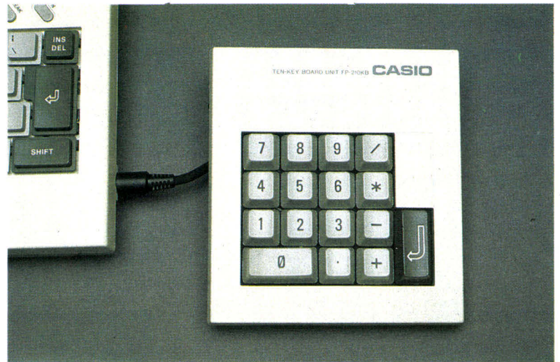
Un clavier numérique peut être en option par les saisies de chiffres à haute vitesse.
