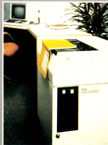
Le lecteur optique KDEM 4000 permet de lire tous les types de documents imprimés ou dactylographiés, même les livres reliés, le sens de lecture pouvant être inversé d'une page à l'autre (photo Kurzweil).
