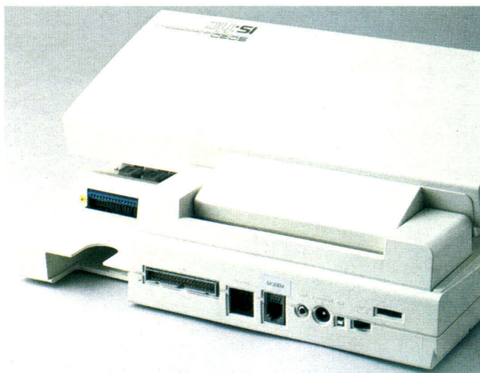
Sur la face arrière, on aperçoit les différents connecteurs : modem, lecteur codes barres, série 232 C, parallèle, et le logement pour cartouches.
