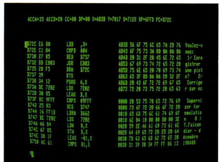
L'écran du Vegas en émulation affichant la valeur des registres, une zone mémoire désassemblée (à gauche) et deux zones mémoire présentées simultanément en hexadécimal et en ASCII.
