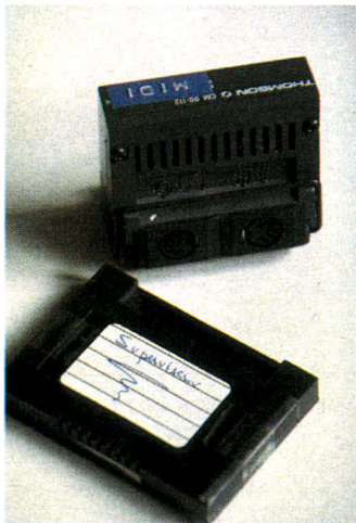
Un logiciel inscrit en ROM et une interface MIDI modifiée sont nécessaires à l'émulation.
