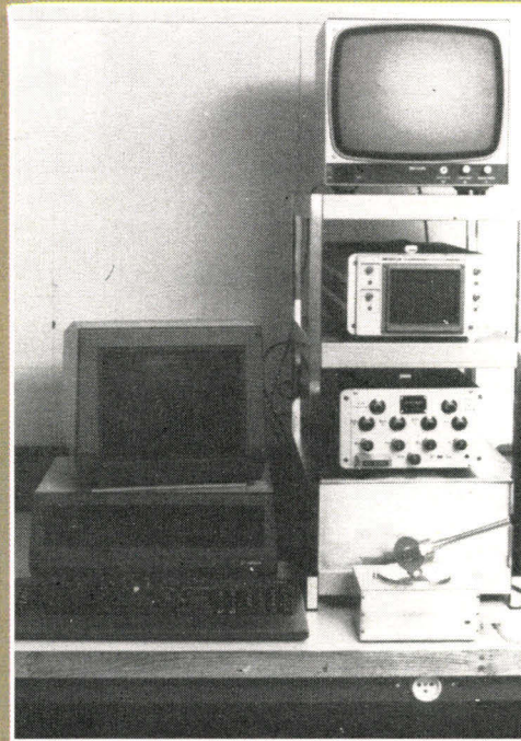
Calculateur analogique de perspective réalisé par le laboratoire de mécanique physique (Paris VI). A gauche, système minimal fonctionnant en autonomie. A droite, couplé à un micro-ordinateur et muni d'un moniteur de visualisation à grand écran.
