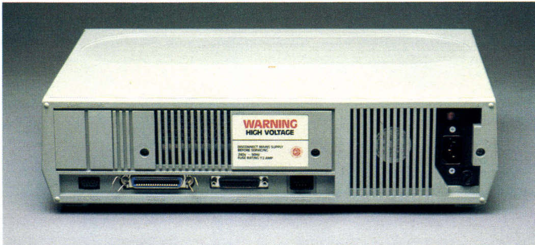
Photo 10. – L'arrière du PC/Xi montre les interfaces série et parallèle présentes sur tous les modèles Apricot.
