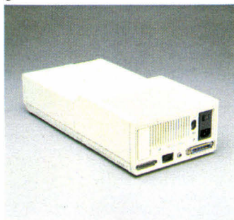
Photo 5. - L'arrière du F10 intègre les interfaces parallèle et série.
