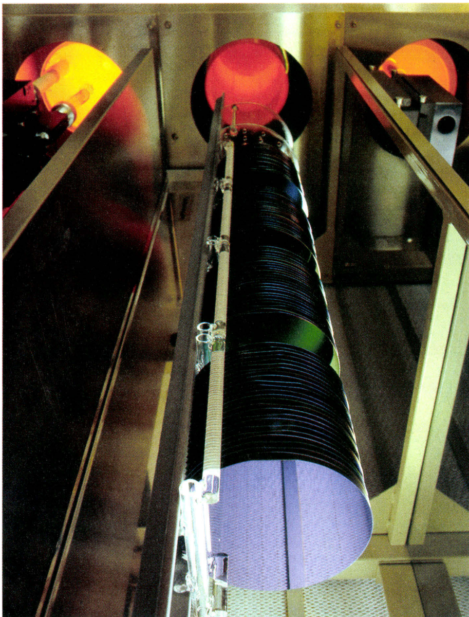
L'entrée des tranches de silicium dans un four.
