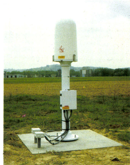
Un capteur de foudre, de 800 km de portée. (Doc. Météorage Franklin)
