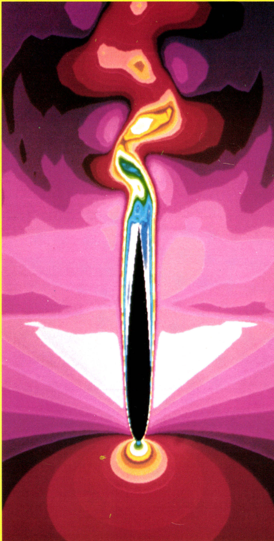
Simulation numérique, à l'Onera, des écoulements visqueux de fluide compressible. Carte des nombres de Mach autour d'un profil ( \alpha = 0^\circ - M = 0,85 - Rc = 10\ 000 ).
