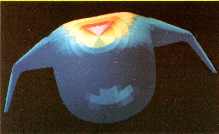
Simulation numérique, à l'Onera, de la répartition de pression sur l'avion spatial Hermès en régime hypersonique (doc. Onera).
