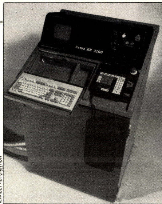
Système de commande Acma BR 2200, destiné au pilotage de robots de production robotisées.
