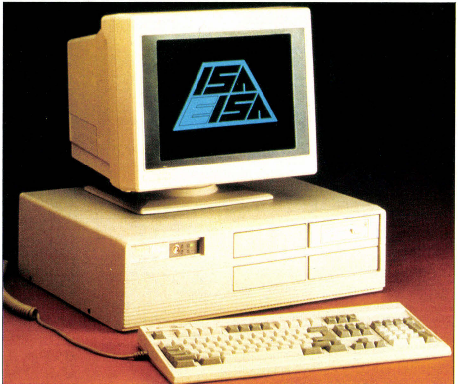
Le Z-386/33E de Zenith. En dehors de son contrôleur de disque et de ses connecteurs EISA, il est pratiquement identique au précédent système 386 à 33 MHz de Zenith.
