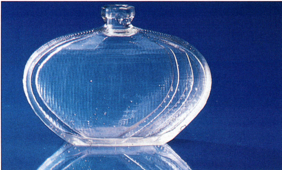
Spectra Physics, flacon de parfum réalisé en résine transparente, sur le SLA 250 de 3D Systems.
