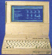
COMPAQ LTE 80C86 à 9,54 MHz - 640 Ko de RAM LCD CGA Disque dur 20 Mo
