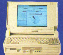
COMPAQ SLT 386s / 20 80386 SX à 20 MHz 2Mo de RAM - LCD VGA Disque dur 60 ou 120 Mo
