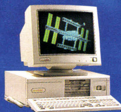
COMPAQ DESKPRO 386 / 33L 80386 DX à 33 MHz 4 Mo de RAM - VGA accéléré Disque dur 120 à 650 Mo
