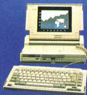
COMPAQ SLT / 286 80C286 à 12 MHz - 640 Ko de RAM LCD VGA Disque dur 20 ou 40 Mo
