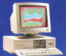
COMPAQ DESKPRO 486 / 33L i486 à 33 MHz 4 Mo de RAM - VGA accéléré Disque dur 120 à 650 Mo
