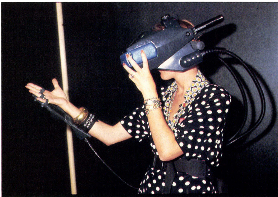
La main est sertie de modules (bagues et bracelet) pour enregistrer le mouvement des articulations.
