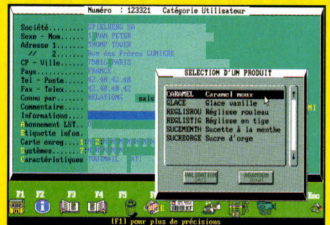
Voici un écran de saisie contrôlée, avec de nombreux champs, des icônes, et une fenêtre (jusqu'à 26 simultanées possibles), ici sous DOS.
